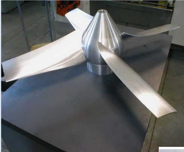
Esta turbina o generador sumergido, cuenta con un canalizador de flujo que acelera localmente la corriente de agua para lograr velocidades adecuadas para generar energía.
